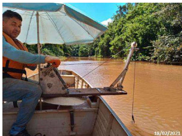
Foto 4 – Detalhe das atividades da medição de vazão no PHJ – 17ª Campanha (Data: 18/02/2021).
