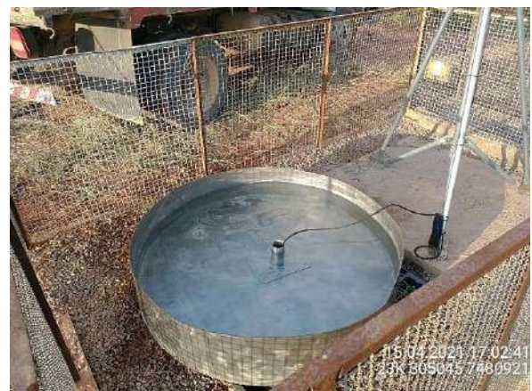
Foto 6 – Reposição de água no reservatório do tanque classe A. (Data: 15/04/2021).
