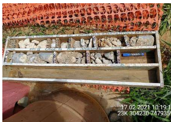
Foto 10 – Caixa testemunhos de sondagem do PM-BP-11. (Data: 17/02/2021).
