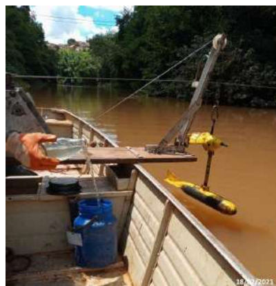
Foto 4 – Coleta de sedimentos em suspensão no PHJ – 17ª campanha. (Data: 18/02/2021).
