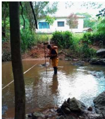
Foto 3 – Medição da descarga sólida no Psed – 18ª campanha. (Data: 17/02/2021).
