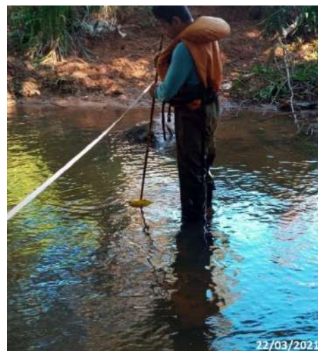
Foto 6 – Coleta de dados com o amostrador de sedimentos PSed – 19ª campanha. (Data: 23/03/2021).
