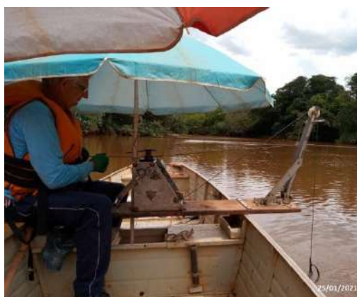
Foto 1 – Vista geral da medição de vazão no PHM – 17ª Campanha. (Data: 25/01/2021).
